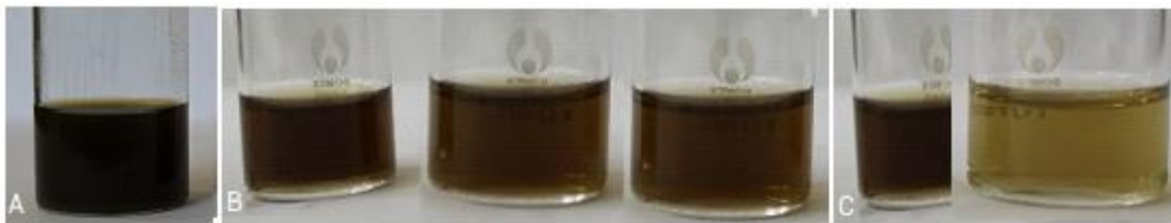
Fig. -1 - Clarificación de extracto acuoso crudo de S. rebaudiana . A) Sin clarificar. B) Ciclos de clarificación con carbón activado. C) Ciclos de clarificación con semilla desnuda, desengrasada y triturada de M. oleifera .
